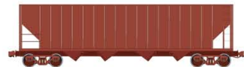
wagon M -trémie F à minérali M hopper ore car vagón M tolva F para minerales M Schüttgutwagen M carro M a tramoggia F per minerali M
